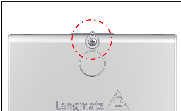
Abb. 2 a Verschluß mit unverlierbarer Schraube
