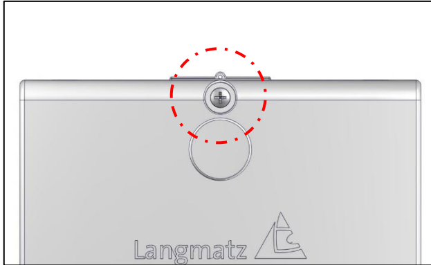
Abb. 2a Verschluß mit unverlierbarer Schraube
