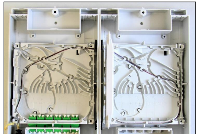
Abb. 25 Faserführung bei Anreihung
