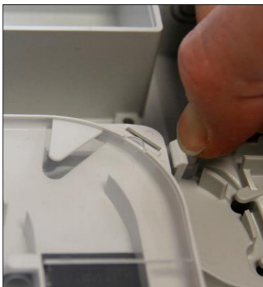
Abb. 12 Beim Öffnen der Kassette Rasthaken zurückziehen.
