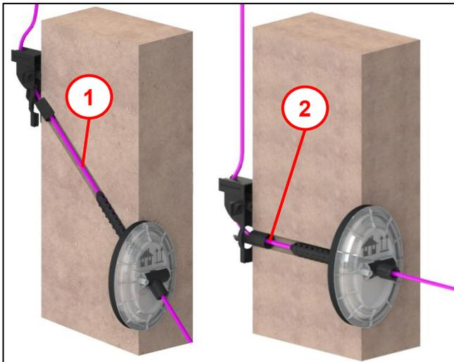
Der Einbau kann sowohl gerade 90° **(2)** als auch schräg **(1)** bis 45° Neigung nach oben erfolgen und ist in beiden Fällen gleich vorzunehmen.
